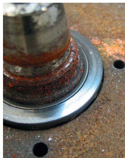
Поврежденная контактная зона уплотнения: рабочая поверхность скольжения была разрушена инородными частицами
